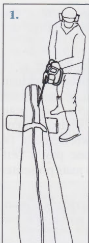
1. Le fustier fait, en poussant la tronçonneuse, une saignée de 1 cm de profondeur (ill. 122 a)
