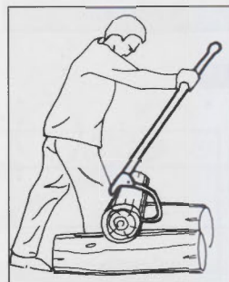
8 Pour bloquer le rondin de manière à le retourner au tourne-bille sans le déplacer, le fustier se sert souvent...
