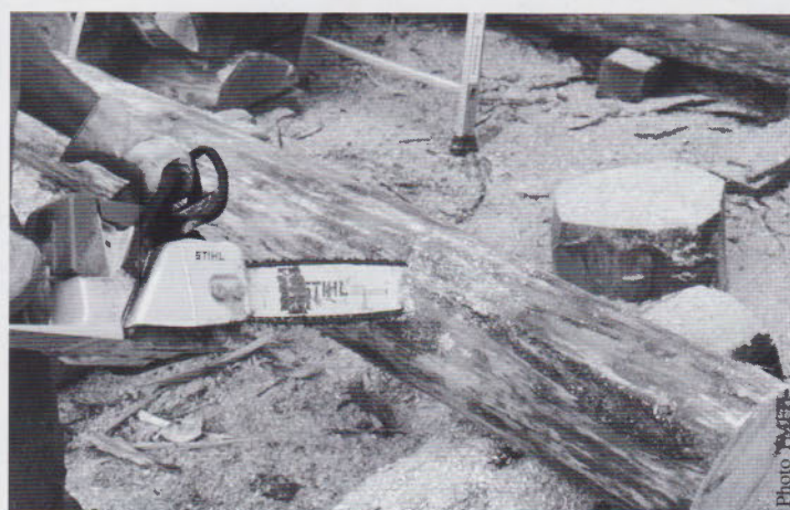
47 Découpe d'une entaille d'angle
