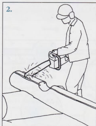
2. Puis il commence la découpe des goulottes par un trait de scie transversal.
