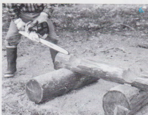
6. Puis il brosse l'intérieur de l'entaille pour se rapprocher du trait et obtenir une « goulotte » au profil arrondi (ill. 120.3).
