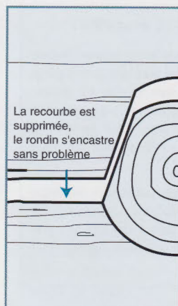
2. On peut résoudre le problème en faisant un plat sur A avant traçage.
