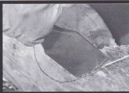
Inciser le contour de la gueule en laissant le trait apparent.
