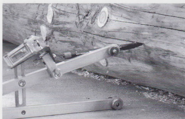
(7) Tracer un encastrement de plancher
