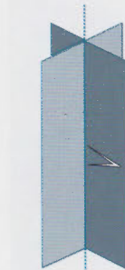
38 L'alignement des branches du compas correspond à la ligne d'intersection de deux plans perpendiculaires
